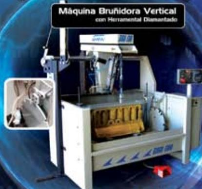
Máquina Bruñidora Vertical con Herramental Diamantado
