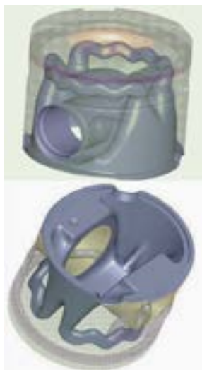
Fig. 12: Galería de enfriamiento
