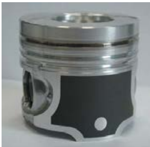
Fig. 1: Revestimiento parcial de la falda (Con punto de medición)
