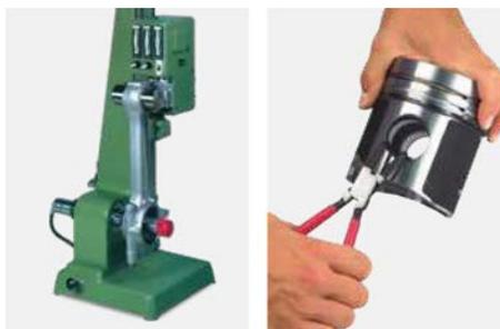
Antes de montar las bielas, se debe controlar con un comprobador apropiado si estas están dobladas o torsionadas. La divergencia no puede superar 0,02 mm sobre 100 mm. Coloque el pistón y la biela siguiendo la dirección de montaje. A continuación, el ojo de biela ya puede alojar el bulón del pistón. Introducir lentamente y con cuidado el bulón previamente lubricado en los agujeros del bulón del pistón y en el pie de la biela. Al hacerlo, deben evitarse los movimientos bruscos.
