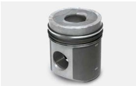
El pistón no puede tornearse para ajustar el saliente del mismo. Hay pistones para ajustar con altura de compresión reducida. En la mayoría de los casos, la dimensión de la altura de compresión se divide en niveles entre 0,2 y 0,6 mm.
