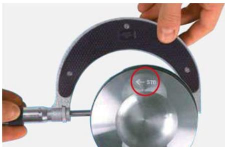
Kolbenschmidt utiliza productos de conservación respetuosos con el aceite de motor. Por eso no resulta necesario limpiar los pistones. En la cabeza del pistón se indican el diámetro del pistón, el juego de montaje y la dirección de montaje (p. ej., lecha). Tenga en cuenta que el diámetro del pistón más el juego de montaje dan como resultado el diámetro del cilindro.
