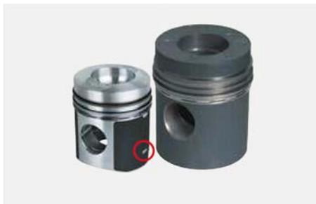
En pistones con capa de graito aún se deben deducir de 0,015 a 0,02 mm de espesor de la capa de la cota medida para obtener la cota de falda grabada. En caso de pistones grafitados mediante serigrafía, solo se puede medir el diámetro de la falda en los puntos de medición previstos para ello, no en superficies sin capa de grafito.
