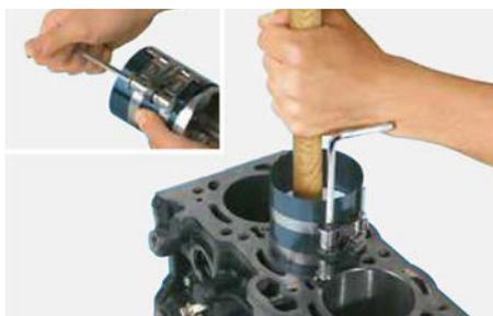
Limpie cuidadosamente el bloque motriz. Al hacerlo, preste atención a que todas las superficies de deslizamiento estén libres de suciedad y bien lubricadas. Comprima los segmentos de pistones con un manguito anular para posibilitar un deslizamiento sin resistencia del pistón en el calibre del cilindro. En caso de motores diésel, mida el saliente del pistón y siga siempre las indicaciones del fabricante.
