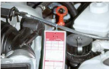
El aceite caliente que circula con rapidez elimina las partículas extrañas del motor que aún puedan quedar adheridas después del reacondicionamiento. Estas impurezas se acumulan en el aceite de motor y el filtro de aceite, solo se necesitan 50 km para acumular una gran cantidad de partículas de suciedad. No se deberían recorrer más de 500 km con el primer llenado de aceite.
